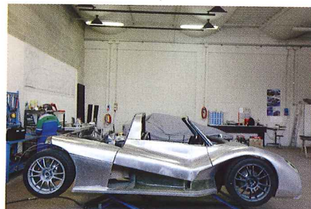
L'alluminio prende forma intorno ai filoni dell'intelaiatura. Qui la forme della Seiottosei si cominciano a delineare davanti al disegno scala 1/1
