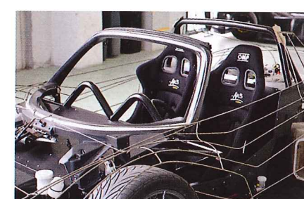
La struttura in filoni per plasmare la carrozzeria viene ancorata al telaio: su questa lavoreranno in modo artigianale i battilastra specializzati
