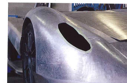
La carrozzeria in alluminio e carbonio della Seiottosei in avanzato stato costruttivo. Qui sopra, al centro, il dettaglio del volante, che non è ancora quello definitivo
