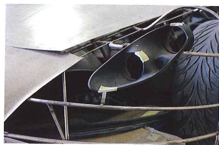
L'alluminio prende forma intorno ai filoni dell'intelaiatura. Qui la forme della Seiottosei si cominciano a delineare davanti al disegno scala 1/1
