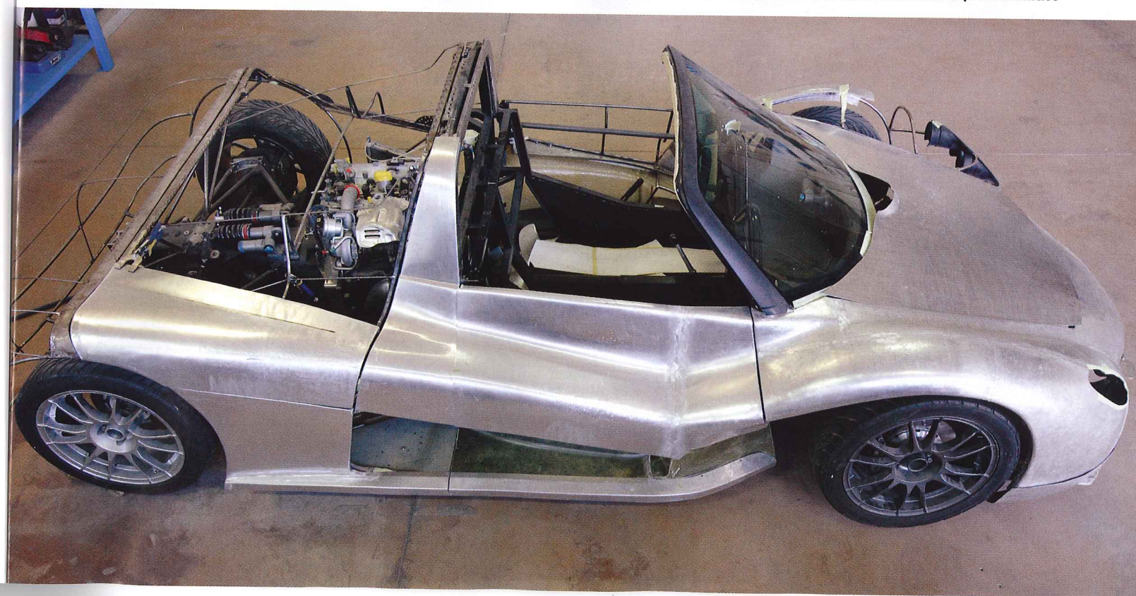
La carrozzeria in alluminio e carbonio della Seiottosei in avanzato stato costruttivo. Qui sopra, al centro, il dettaglio del volante, che non è ancora quello definitivo
