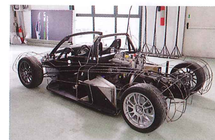
La struttura in filoni per plasmare la carrozzeria viene ancorata al telaio: su questa lavoreranno in modo artigianale i battilastra specializzati
