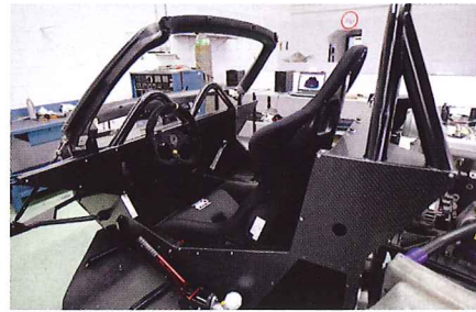
Nelle immagini, alcuni passaggi della lavorazione del telaio della Seiottosei, con la nuda struttura in bella evidenza e il telaio in tubi integrato ai pannelli in carbonio
