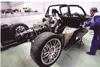
Nelle immagini, alcuni passaggi della lavorazione del telaio della Seiottosei, con la nuda struttura in bella evidenza e il telaio in tubi integrato ai pannelli in carbonio
