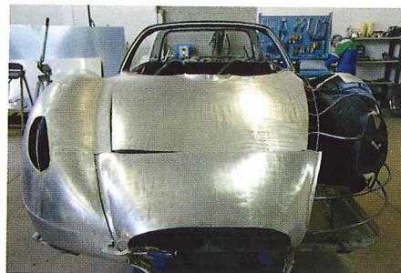
L'alluminio prende forma intorno ai filoni dell'intelaiatura. Qui la forme della Seiottosei si cominciano a delineare davanti al disegno scala 1/1
