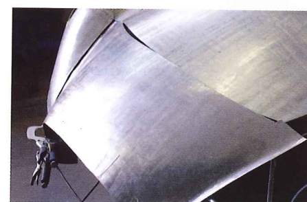
La carrozzeria in alluminio e carbonio della Seiottosei in avanzato stato costruttivo. Qui sopra, al centro, il dettaglio del volante, che non è ancora quello definitivo
